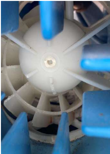
Fotografías 18 y 19 – Detalles del Contador CHT (Desmontado) del Pozo Nº1 – Hélice rota.
